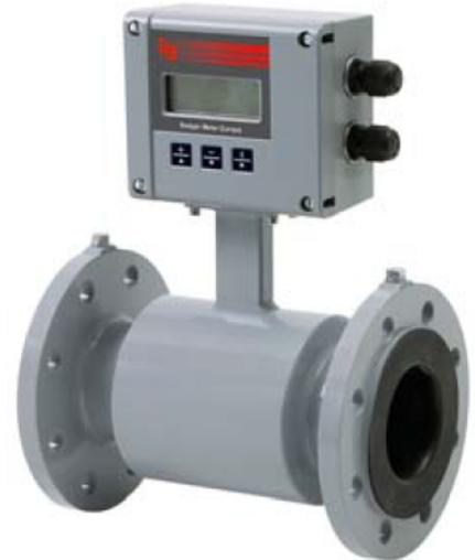
Le principe de la mesure de débit repose sur la loi de Faraday. La tension induite par un conducteur en mouvement au travers d'un champ magnétique est directement proportionnel à la vitesse du conducteur. La tension induite est mesurée aux bornes de deux électrodes diamétralement opposées. Cette tension est proportionnelle au champ magnétique, à la distance entre les deux électrodes et à la vitesse moyenne du fluide.
