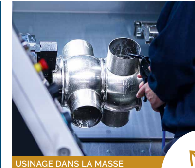
USINAGE DANS LA MASSE
