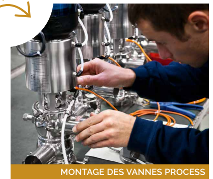
MONTAGE DES VANNES PROCESS
