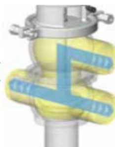
VANNE FERMÉE Circulation voie haute
