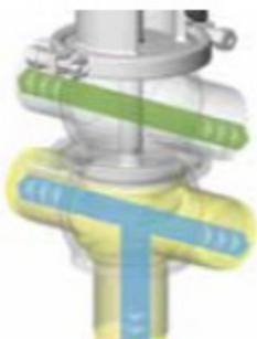
VANNE OUVERTE Circulation voie basse
