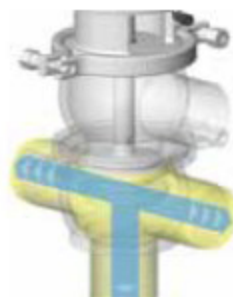
VANNE OUVERTE Circulation voie basse
