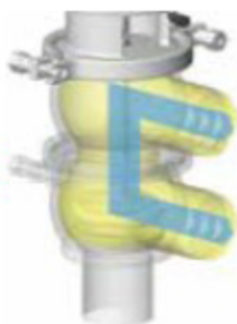
VANNE FERMÉE Circulation voie haute
