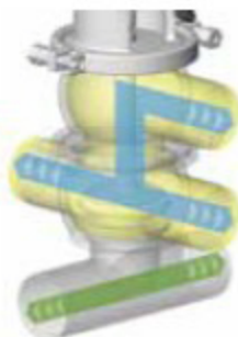
VANNE FERMÉE Circulation voie haute
