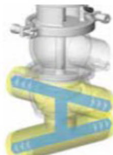
VANNE OUVERTE Circulation voie basse
