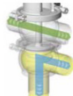
VANNE OUVERTE Circulation voie basse
